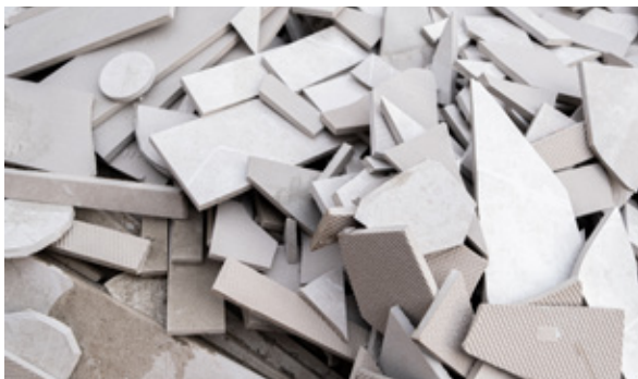
Keramiske fliser som blir ødelagt før eller etter brenning samles opp for å bli sendt tilbake til produksjonen.
